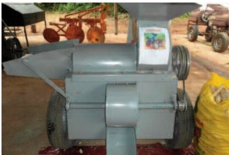
Photo 20 : Egrenouse vanneuse à maïs AZIZA
